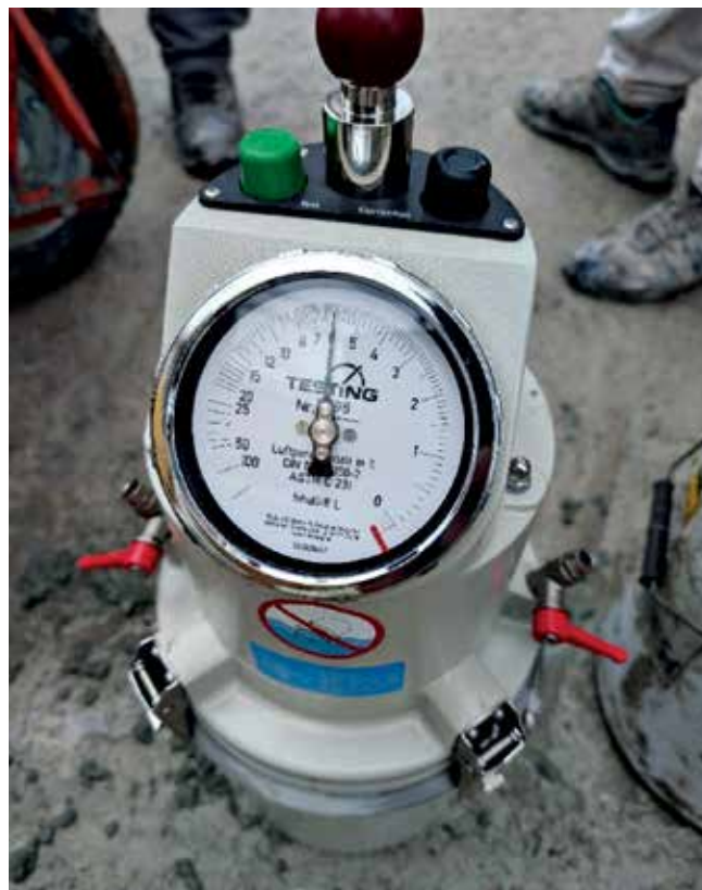
Δοκιμή αεροπεριεκτικότητας νωπού σκυροδέματος
