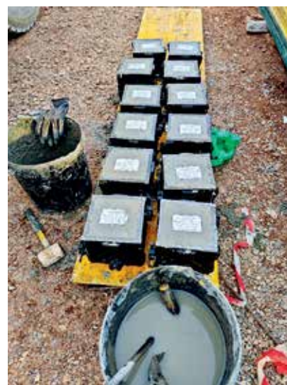
Δειγματοληψία δοκιμών σκυροδέματος
